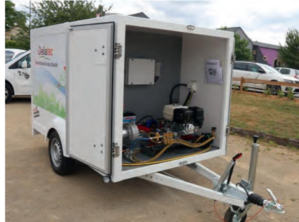
Ce désherbeur utilise la technologie dite « désherbage à gouttelettes d'eau chaude » voire désherbage vapeur. Cette méthode permet de désherber de manière efficace et écologique, car elle ne nécessite aucun pesticide. Le fonctionnement du désherbage à eau chaude est simple : l'eau est chauffée à +/-120 °C, puis est pulvérisée sur les mauvaises herbes. Ces dernières sont alors victimes d'un choc thermique et sont détruites.
